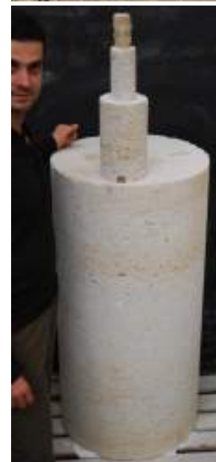
Μελέτη του Κογχυλιάτη Λίθου, υλικού κατασκευής του Ναού του Διός στην Ολυμπία στην Εργαστηριακή Μονάδα «Φυσικών Δομικών Λίθων» του ΕΑΥ/ΕΜΠ
