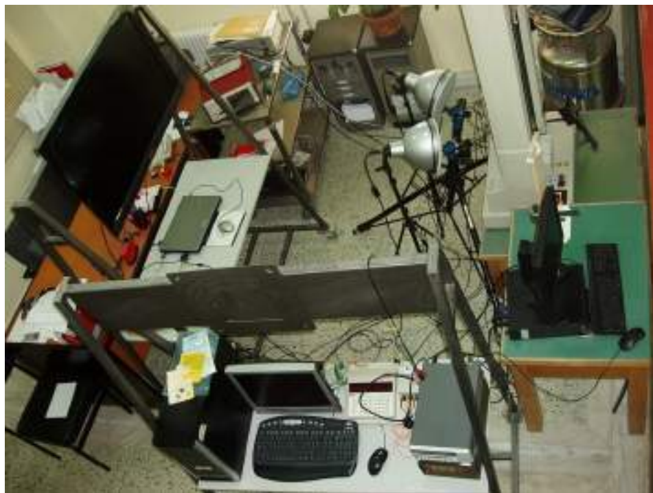
Πείραμα με χρήση διατάξεων «3D-DIC», «Καταγραφής Ακουστικών Εκπομπών» και «Καταγραφής Προδρόμων της Αστοχίας Ηλεκτρικών Σημάτων» στην Εργαστηριακή Μονάδα «Εμβιομηχανικής» του ΕΑΥ/ΕΜΠ
